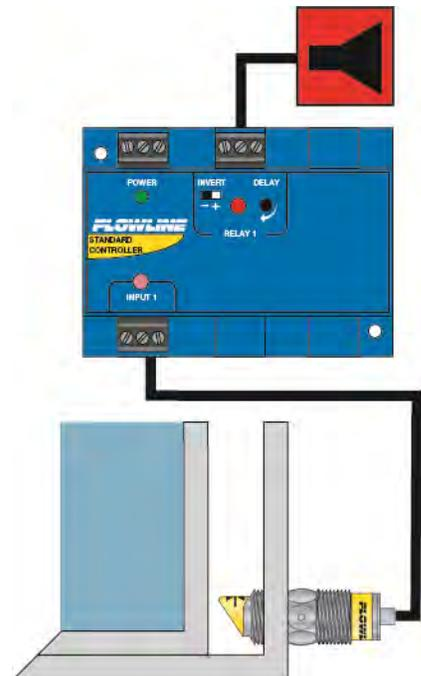
**RELAY LOGIC – AUTOMATIC FILLING AND EMPTYING**
