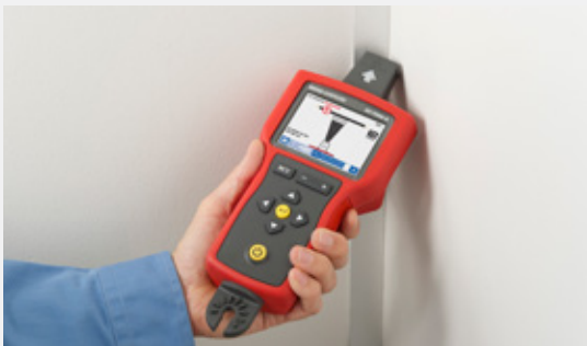
Use el sensor de punta para rastrear cables en zonas de difícil acceso.
