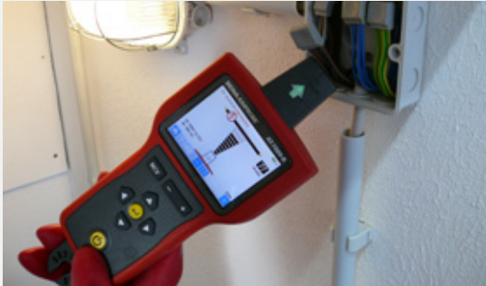
Rastree cables con o sin tensión retirando la cubierta de la caja de conexiones.
