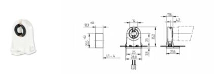
L1-4: Nella determinazione definitiva della distanza dei fori si deve di volta in volta tener conto delle dimensioni della lampada e dell'apparecchio di illuminazione.
