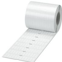
Gewebeetikett, Rolle, weiß, unbeschriftet, beschrifbar mit: THERMOMARK E.300 (D)/600 (D), THERMOMARK ROLL 2.0, THERMOMARK ROLL, THERMOMARK ROLL X1, THERMOMARK ROLLMASTER 300/600, THERMOMARK X1.2, Montageart: kleben, Anzahl der Einzelschilder: 10000, Textfeldhöhe: 5,5 mm, Textfeldbreite: 20 mm
