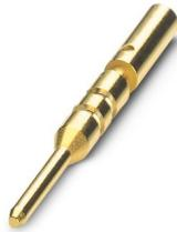
压接插针，针式插头，车削，触点直径: 0.8 mm，压接范围: 0.34 mm<sup>2</sup> ... 0.5 mm<sup>2</sup>，备选产品符合RoHS II非豁免 6c (Pb < 0.1 %) 产品编号：1244459
