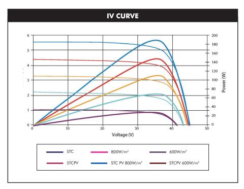
ALL FIGURES TAKEN UNDER THE FOLLOWING STANDARD TEST CONDITIONS: IRRADIANCE 1000W/M², MODULE TEMPERATURE  $25^{\circ}$ C, AM=1.5
