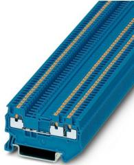
直通式接线端子，标称工作电压: 500 V，额定电流: 17.5 A，连接量: 3，接线方式: 直插式连接，第一层，额定接线容量: 1.5 mm<sup>2</sup>，横截面: 0.14 mm<sup>2</sup> - 1.5 mm<sup>2</sup>，安装方式: NS 35/7.5, NS 35/15，颜色: 蓝色
