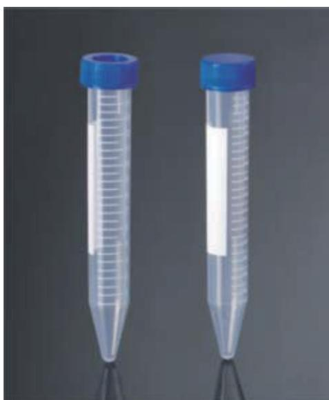
Plage de graduation inférieure : 0,1-1 ml Intervalle de graduation inférieur : 0,1 ml Plage de graduation du tube : 1,5-14,5 ml Intervalle de graduation du tube : 0,5 ml
