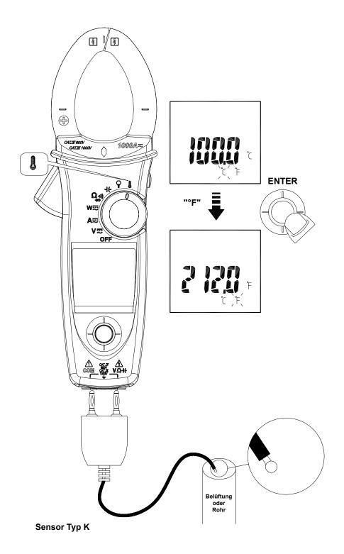
Keinerlei Hochspannungsmessung vor genauen °C/°F Messungen durchführen.
