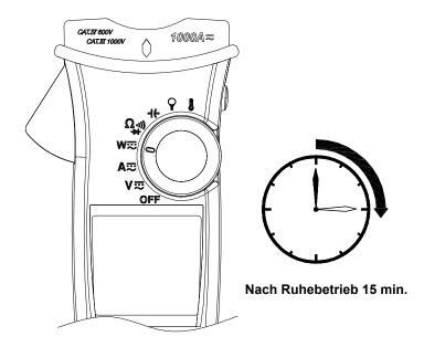
Dass Messgerät kann durch Drehen des Schalters aus der Position AUS heraus wieder in Betrieb gesetzt werden.
