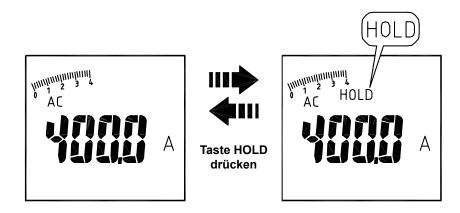
**SMART HOLD**: Das Messgerät erzeugt einen permanenten Warnton, und die Anzeige blinkt, wenn der gemessene Wert über dem auf der Anzeige angezeigten Wert liegt. (Für die Funktionen "V", "A", "W" und Flex AC current).
