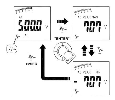
2. Im Modus ACA die Anzeige " ¬¬¬¬¬—" auswählen, dann die Navigationstaste mehr als 2 Sekunden lang drücken, um in den Modus HALTEZEIT DES SPITZENWERTS ¬¬¬— zu wechseln. Um den Modus HALTEZEIT DES SPITZENWERTS ¬¬— zu beenden, die Navigationstaste mehr als 2 Sekunden lang drücken, um zu der Anzeige " ¬¬¬— " zurückzukehren.
