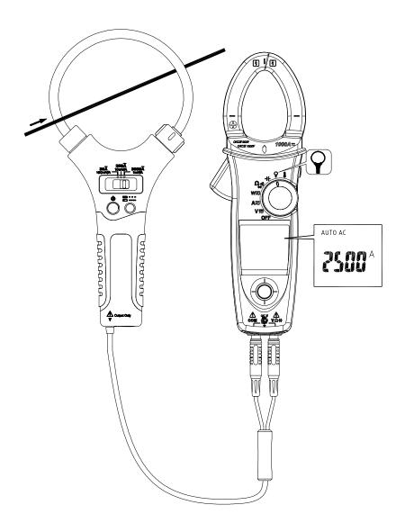
Hinweis: Messung an einem bekannten Stromkreis vornehmen, um sicherzustellen, dass die ICA10T/ICA18T Flexi-Strommessspitze und IPM 240F fehlerfrei arbeiten.
