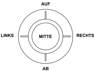
Die Navigationstaste verfügt über 5 Schaltrichtungen auf der Anzeige. Die Navigationstaste kippen, um die gewünschte Funktion auszuwählen und die Funktion durch einen einfachen Klick aktivieren.
