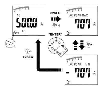
Im Modus HALTEZEIT DES SPITZENWERTS ist das Messgerät dahingehend aktiviert, dass es den positiven Spitzenwert und den negativen Spitzenwert speichert. Der positive Spitzenwert wird im Modus SPITZENWERT MAX angezeigt. Der negative Spitzenwert wird im Modus SPITZENWERT MIN angezeigt.
