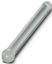
垂直4 mm光导，透明，带球形5.2 mm凸头，可组装在最小壁厚1 mm上，采用聚碳酸酯 (UL 94-V0) 制成，安装长度45 mm，防水，IP68 (EN 50529)
