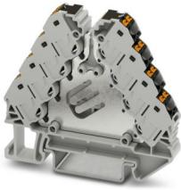
电位分配端子，标称工作电压: 250 V，额定电流: 17.5 A，接线方式: 直插式连接，1, 2, 3及4层，额定接线容量: 1.5 mm<sup>2</sup>，横截面: 0.14 mm<sup>2</sup> - 2.5 mm<sup>2</sup>，安装: NS 35/7,5, NS 35/15，颜色: 灰色，连接元件的颜色: 黑色
