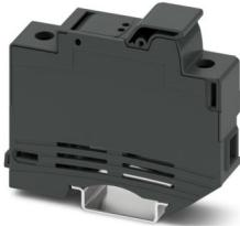
保险丝接线端子，保险丝类型: 陶瓷，保险丝类型: 10.3 x 38 mm，标称工作电压: 690 V AC，额定电流: 32 A，位数: 1，接线方式: 螺钉连接，额定接线容量: 16 mm<sup>2</sup>，接线容量: 1 mm<sup>2</sup>-16 mm<sup>2</sup>，安装方式: NS 35/7,5，NS 35/15，颜色: 黑色
