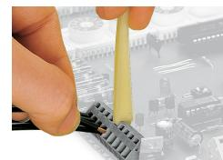
Raccordement des conducteurs, avec outil de manipulation
