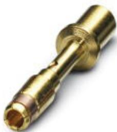
Contacto engastado, mecanizado, Contacto individual, diámetro de contacto: 2 mm, margen para engaste: 1 mm² ... 2,5 mm²
