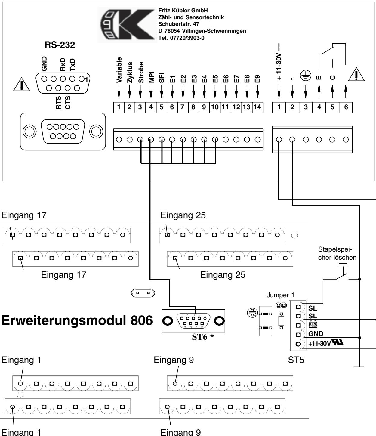
**Stecker ST6 \*** Steckergehäuse ist intern mit (Stecker ST5 Pin 3) verbunden.
