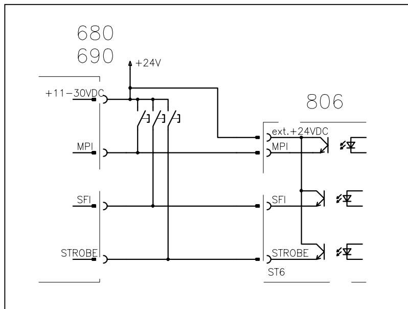
Bei unterschiedlicher Spannungsversorgung von Erweiterungsmodul und Textanzeige müssen die Taster für den externen Anschluß über Dioden entkoppelt werden.
