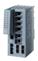
SCALANCE XC206-2 managebarer Layer 2 IE Switch; IEC 62443-4-2 zertifiziert; 6x 10/100 Mbit/s RJ45-Ports; 2x 100 Mbit/s SC-Ports; 1x Konsolen-Port; Diagnose-LED; redundante Spannungsversorgung; Temp.-Bereich-40°C bis +70°C; Montage: Hut-/S7-Profilschiene/Wand; Redundanzfunktionen; Office Features (RSTP, VLAN ,...); PROFINET IO-Device Ethernet/IP-konform C-PLUG Schacht.
