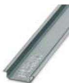
Profilé plein, Profil standard, largeur: 35 mm, hauteur: 7,5 mm, selon EN 60715, matériau: Aluminium, aucun revêtement, longueur: 2000 mm, coloris: argenté
