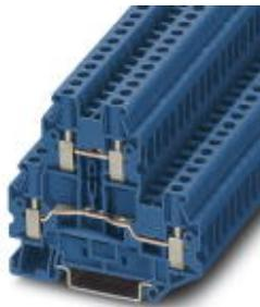
Bloc de jonction à 2 étages à raccordement vissé, section : 0,14 mm<sup>2</sup> - 6 mm<sup>2</sup>, AWG : 26 - 10, largeur : 6,2 mm, coloris : bleu
