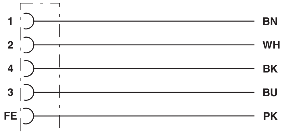
Kontaktbelegung der M12-Buchse
