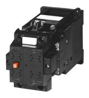
CONTACTOR, SIZE 2, 2-POLE DC-3 AND 5,RATD.OPERAT.CURR.32A AUXILIARY CONTACTS 22 (2NO+2NC) AC OPERATION AC 110V 50HZ/AC 132V 60HZ
