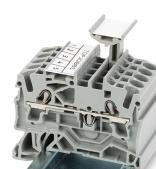
Porte-étiquettes de groupe TOPJOB®S (2009-193), ici avec bandes de marquage, utilisable pour toutes les bornes sur rail TOPJOB®S des séries 2000 à 2016. Ne pas placer par-dessus une plaque d'extrémité !
