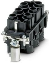
插芯，位数: 6+PE，尺寸: B16，电源针位: 6，控制针位: 0，孔式插头，螺钉连接，1000 V，80 A，6 mm<sup>2</sup> ... 16 mm<sup>2</sup>，应用: 电源
