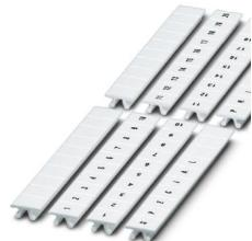
用于端子的标记条，接头，白色，标识，横向打印: 连续编号1 ... 9，安装方式: 锁扣，适用的模块宽度: 8.2 mm，标签数: 10，文本框高度: 10.5 mm，文本框宽度: 8.15 mm
