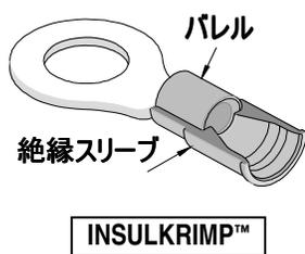
4. Avikrimp™には色分けされたスリーブがあり、被覆グリップと絶縁体の役割を果たします。絶縁体はナイロン製で、補助の錫めっき真鍮スリーブが追加されています。この真鍮サポートスリーブを電線被覆に圧着させると、張力が緩和されるため、電線の振動、緩み、擦り切れ、断線の防止につながります。対応電線サイズは10～26 AWG (0.10～6.60mm<sup>2</sup>) です。
