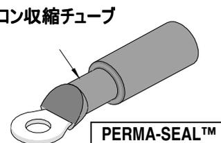
8. アイレットはCDA-110 (電解精銅) から深絞りされた後に錫めっきが施され、防食性が向上しているため、標準圧縮端子の代わりに使用できます。この端子のバレルには継ぎ目がなく、挿入口にフレアが付いています。対応電線サイズは8~500 MCMです。
