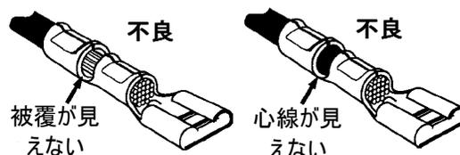
4. 被覆サポート圧着がない場合、心線圧着部の後方に見える心線の長さが被覆直径未満であることを確認します。見えている心線の長さが被覆直径を超えていると、端子は短絡の原因になる可能性があります。
