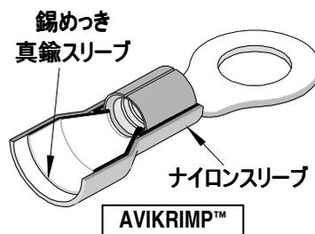
5. オープンバレル製品は、大量の加工が要求される製造工程で使用されます。オープンバレルは圧着が簡単で、加工に必要な時間を短縮できます。自動電線加工装置を使用するときには、オープンバレルの方が好まれます。
