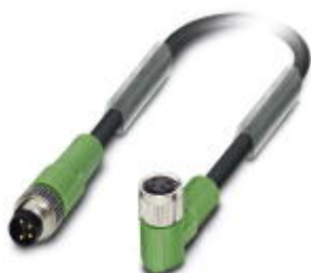
センサ/アクチュエータケーブル, 4-極, PUR ハロゲンフリー, 黒-灰RAL 7021, プラグ ストレート M8, 上 ソケット アングル M8, ケーブル長: 1.5 m
