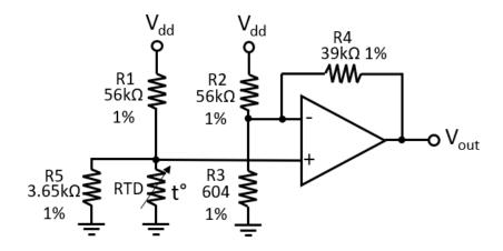
$$\underline{V_{\text{out}}} = \frac{\left[\frac{R_{\text{RTD}} \times R5}{R_{\text{RTD}} + R5}\right] \times \underbrace{V_{\text{dd}}}_{\text{R}}}_{\text{R1} + \left[\frac{R_{\text{RTD}} \times R5}{R_{\text{RTD}} + R5}\right]} \times \left[1 + R4 \times \left[\frac{1}{R2} + \frac{1}{R3}\right]\right] - \frac{R4 \times \underbrace{V_{\text{dd}}}_{\text{R2}}}_{\text{R2}}$$
