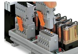
Connexion enfichable des circuits imprimés
