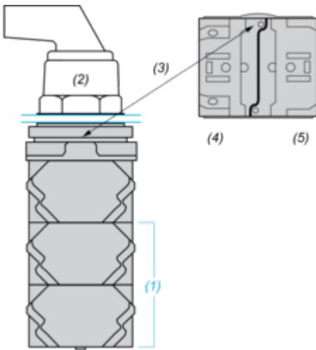
(1) Il est possible de monter jusqu'à 3 niveaux de blocs de contacts (6 blocs maximum)
