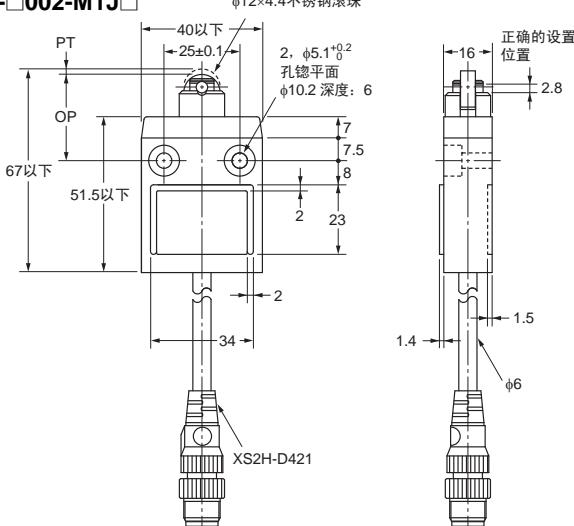
**注：** 上述各机型的外形尺寸图中的未注公差为 $\pm 0.4\text{mm}$ 。
