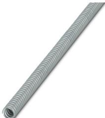
Schutzschlauch, Material: PVC, Wendel: PVC ummantelter Federstahl, UV-beständig: nein, flexibel, Schutzart: IP68, Farbe: grau, Innendurchmesser: 10 mm, Gesamtlänge: 10 m
