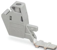
分接接线端子，标称工作电压: 1000 V, 额定电流: 32 A, 连接量: 1, 接线方式: 螺钉连接, 横截面: 0.14 mm<sup>2</sup> - 6 mm<sup>2</sup>, 安装方式: 安装在基座上, 颜色: 灰色
