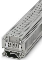
热磁电压接线端子，R型TC，标称工作电压: 400 V，额定电流: 1 A，连接量: 4，位数: 2，接线方式: 螺钉连接，第一层，横截面: 0.2 mm<sup>2</sup> - 4 mm<sup>2</sup>，安装方式: NS 35/7,5，NS 35/15，NS 32，颜色: 灰色
