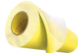
Montez votre plaque photopolymère sur les cylindres d'impression avec le Ruban pour fixation de plaque Cushion-Mount™ Plus 3M™ L1320. Notre ruban mousse double face, jaune, de 0,51 mm, est doté d'une fonction d'évacuation d'air avec retrait facile du côté de la plaque. Il tolère les contaminants de l'encre, ce qui permet un retrait facile et propre de la plaque et est utilisé pour des travaux de combinaison (les demi-tons dépassant les encres solides).
