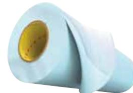
Montez votre plaque photopolymère sur les cylindres d'impression avec le Ruban pour fixation de plaque Cushion-Mount™ Plus 3M™ L1820. Le ruban mousse double face, bleu, de 0,51 mm, est doté d'une fonction d'évacuation d'air avec retrait facile du côté de la plaque. Il tolère les contaminants de l'encre, ce qui permet un retrait facile et propre de la plaque et est utilisé pour les plaques contenant principalement des encres solides en combinaison.
