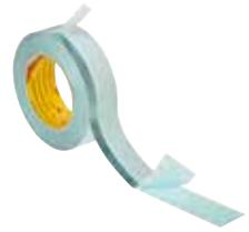
Le Ruban déroulable à la volée et retriturable 3M™ 9353 est notre construction de ruban double face, à séparation, conçu pour dérouler à la volée en ligne droite. Il est muni d'un adhésif acrylique retriturable sur les deux faces et d'un protecteur en papier facile à retirer (également retriturable), avec une protection marquée pour de bons résultats d'application manuelle.
