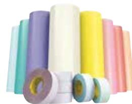
Montez votre plaque photopolymère sur les cylindres d'impression avec le Ruban pour fixation de plaque Cushion-Mount™ Plus 3M™ E1920H. Notre ruban mousse double face, rose, de 0,51 mm, est doté d'une fonction d'évacuation d'air avec une adhésion élevée du côté de la plaque. Il est utilisé à vitesse élevée lorsque le procédé et les images en demi-tons prédominent.
