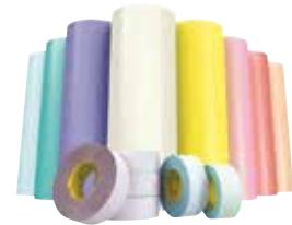
Montez votre plaque photopolymère sur les cylindres d'impression avec le Ruban pour fixation de plaque Cushion-Mount™ Plus 3M™ E1720H. Notre ruban mousse double face, bleu sarcelle, de 0,51 mm, est doté d'une fonction d'évacuation d'air avec une adhésion élevée du côté de la plaque. Il est utilisé lorsque vous avez légèrement plus d'encre solides dans une combinaison d'impressions d'encre solides et de demi-tons.
