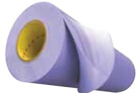
Montez votre plaque photopolymère sur les cylindres d'impression avec le Ruban pour fixation de plaque Cushion-Mount™ Plus 3M™ L1520. Notre ruban mousse double face, violet, de 0,51 mm, est doté d'une fonction d'évacuation d'air et tolère les contaminants de l'encre, ce qui permet un retrait facile et propre de la plaque. Il est utilisé pour des travaux de combinaison.
