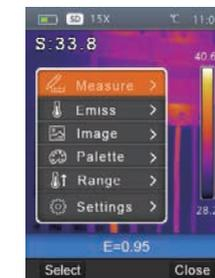
**Maßnahme:** Einstellung für die Berechnung und Anzeige von radiometrischen Temperaturmessdaten in Bezug auf die thermischen Bilder.
