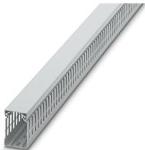
制御盤への設置、取付け用ケーブルダクト、ライトグレー、ハロゲンフリー、上部と取付け用ベースで構成、幅：40 mm、高さ：60 mm、長さ：2000 mm
