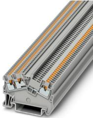
直通式接线端子，标称工作电压: 500 V，额定电流: 17.5 A，连接量: 3，接线方式: 直插式连接，第一层，额定接线容量: 1.5 mm<sup>2</sup>，横截面: 0.14 mm<sup>2</sup> - 1.5 mm<sup>2</sup>，安装方式: NS 35/7.5，NS 35/15，颜色: 灰色
