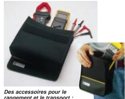
Le lot C.A 5205G + minipince MN 89 : mesure de 0,5 A à 240 A~ en toute simplicité et sécurité. Rapport sortie/entrée de la minipince : 100 mV ∴ / 1 A~.
