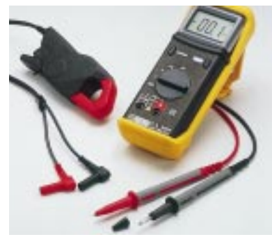
Le lot C.A 5205G + minipince MN 89 : mesure de 0,5 A à 240 A~ en toute simplicité et sécurité. Rapport sortie/entrée de la minipince : 100 mV ∴ / 1 A~.
