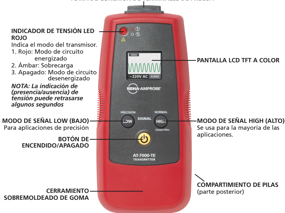
Figura 2: Descripción general del transmisor AT-7000-TE
