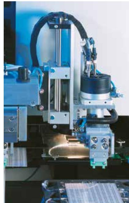
Laserabgleich von Platin-Chip-Temperatursensoren
