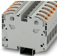
大电流接线端子，标称工作电压: 1000 V，额定电流: 125 A，连接量: 2，接线方式: PowerTurn连接，额定接线容量: 35 mm<sup>2</sup>，横截面: 2.5 mm<sup>2</sup> - 35 mm<sup>2</sup>，安装方式: NS 35/15，颜色: 灰色
