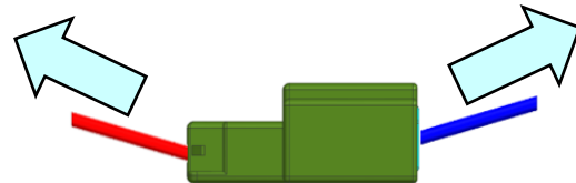
Fig.10-3-5 電線を極端に曲げる又は、突っ張った状態
