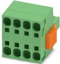
印刷电路板TWIN插头，额定横截面: 6 mm<sup>2</sup>，颜色: 绿色，额定电流: 32 A，额定电压(III/2): 1000 V，触点表面: Sn，触点类型: 孔式插头，电位数: 4，行数: 1，位数: 4，连接量: 8，产品系列: TSPC 5/..-STCL，针距: 7.62 mm，接线方式: 直插式弹簧连接，导线/PCB连接方向: 0°，锁扣: - 不带锁扣，插拔系统: COMBICON PC 5，互锁: 锁紧装置，安装方式: Click & Lock卡销，包装类型: 纸箱包装
