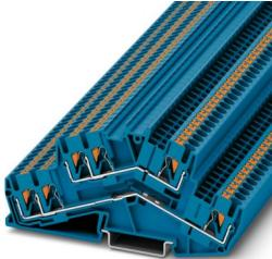
双层接线端子，标称工作电压: 800 V，额定电流: 20 A，接线方式: 直插式连接，第一和第二层，额定接线容量: 2.5 mm<sup>2</sup>，横截面: 0.14 mm<sup>2</sup> - 4 mm<sup>2</sup>，安装方式: NS 35/7,5，NS 35/15，颜色: 蓝色
