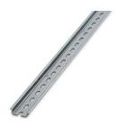
DINレール、取付け穴あり、EN 60715準拠、部材: スチール、亜鉛メッキ加工、白パッシブ、標準プロファイル、色: 銀、25本パック(50 m)
