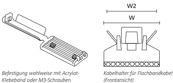
Befestigung wahlweise mit Acrylat-Klebeband oder M3-Schrauben
