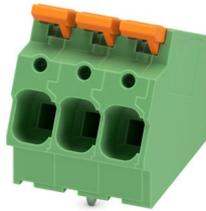
印制电路板终端，额定电流: 41 A，额定电压(III/2): 1000 V，额定横截面: 6 mm<sup>2</sup>，电位数: 3，行数: 1，每行位数: 3，产品系列: LPTA 6/，针距: 7.5 mm，接线方式: 直插式连接，安装: 波峰焊，导线/PCB连接方向: 30°，颜色: 绿色，针脚排列: Z型针脚W，焊针[P]: 3.6 mm，包装类型: 纸箱包装
