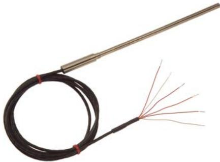
De minéral isolé Duplex PRT deux détecteurs de PT100 indépendant à l'intérieur de la pointe de la sonde. Cela permet à une sonde d'être connecté à deux mesures ou dispositifs de commande ; Alternativement, un capteur peut servir comme un principal et l'autre comme une sauvegarde, éliminant le besoin d'enlever et de remplacer la sonde si un des capteurs cesse de fonctionner.
