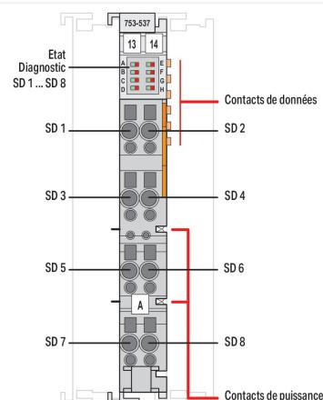
L'automate programmable transmet ses signaux de commande aux actionneurs connectés par l'intermédiaire des bornes de sorties digitales. Toutes les sorties sont protégées contre les courts-circuits.
