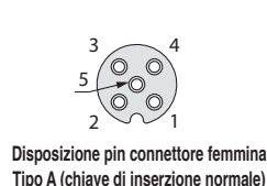
Disposizione pin connettore ad innesto Tipo A (chiave di inserzione normale)
