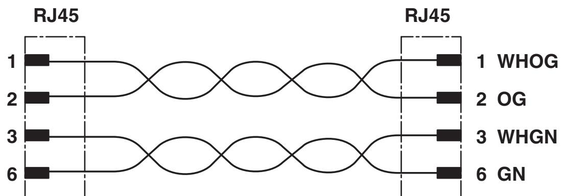
Kontaktbelegung der RJ45-Stecker
