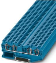
直通式接线端子，标称工作电压: 800 V，额定电流: 32 A，连接量: 4，接线方式: 回拉式弹簧连接，第一层，额定接线容量: 4 mm<sup>2</sup>，横截面: 0.08 mm<sup>2</sup> - 6 mm<sup>2</sup>，安装方式: NS 35/7.5, NS 35/15，颜色: 蓝色
